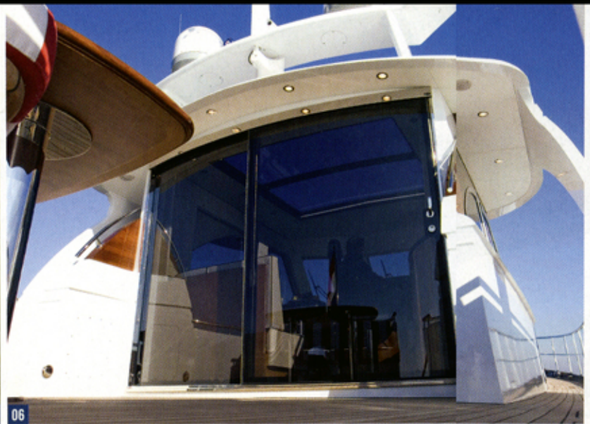
05 Indrukwekkende spiegel. 06 De achterwand van het stuurhuis is een volledige glaswand in smalle rvs-profielen. 07, 08 en 09 Stuurstand en instrumentenpaneel.
