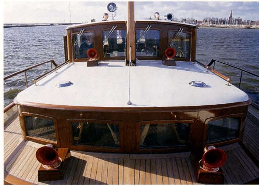
Holz, Holz, Holz: Auf dem Deck der Krabbersbank liegt massives Teak. Die Aufbauten bestehen aus einem Mahagoni-Finish auf Komposit.
